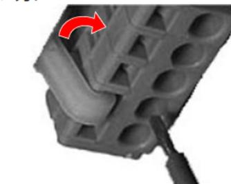
レバーを指で押し、中のスプリングを押し下げます。
